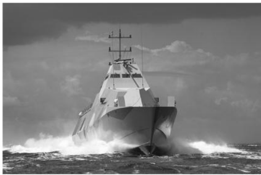
Das schwedische Wegwerfkriegsschiff: Die Korvette Visby schlüpft dank ihrem Rumpf und ihren Aufbauten aus einer PVC-Glasfaserverbindung leicht an Radargeräten vorbei
